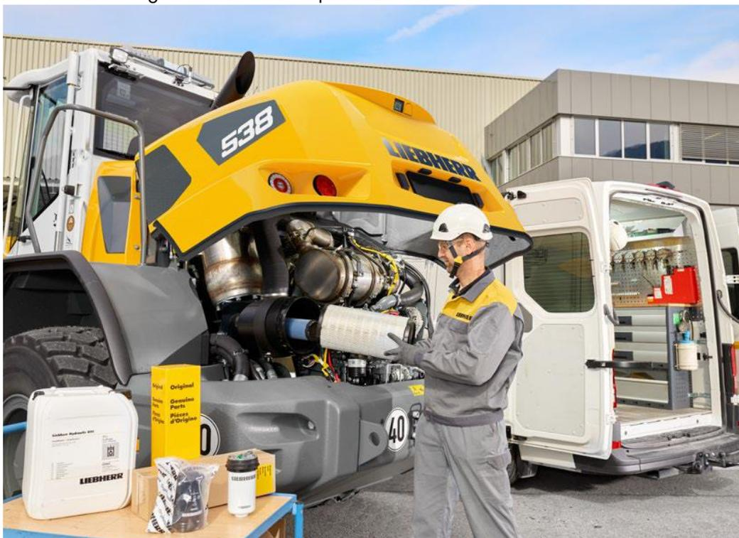
**Facilità di accesso per manutenzioni** - Grazie alla disposizione unica dei componenti, le pale gommate LIEBHERR offrono una eccellente accessibilità a tutti i punti di manutenzione, offre totale accesso a tutti i componenti ed accessori presenti nel vano motore, il posizionamento del sistema di raffreddamento dietro la cabina; sono accorgimenti progettuali che consentono delle manutenzioni periodiche agevoli e sicure.
